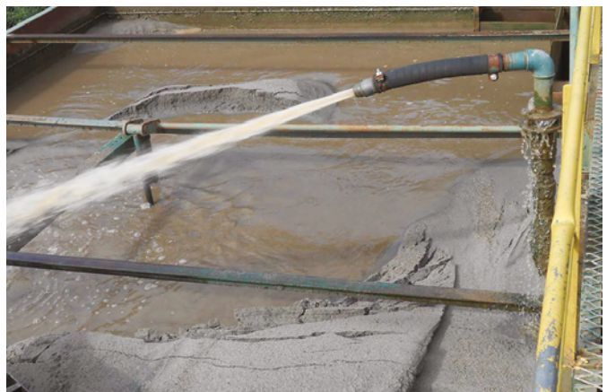
Fotos 12 e 13 – Sistema de decantação e utilização da água de reúso no beneficiamento de areia. Fonte: Pirâmide.
